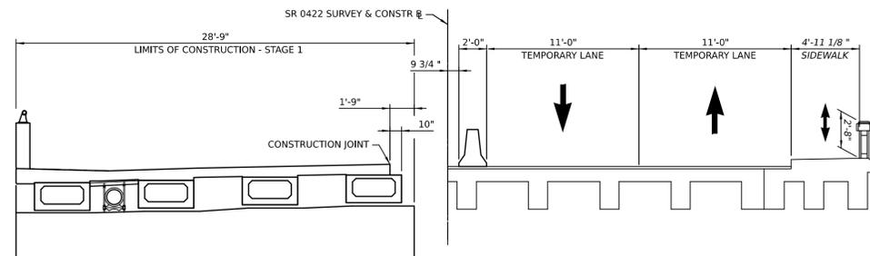
TYPICAL SECTION - STAGE 1 CONSTRUCTION
